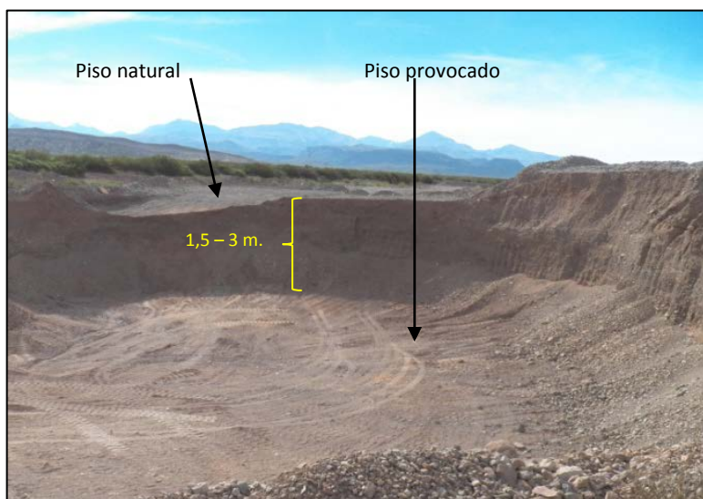
Foto 23: Se muestra la diferencia de pisos en zona de extracción de cantera
